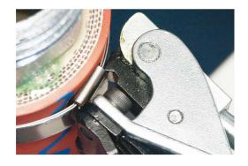
Schlauch mit der Schelle so weit nach hinten drehen, daß der Scherhaken hinter die Schlaufe greifen kann. Dabei gleichzeitig die Kurbel um ca. eine halbe Umdrehung (je nach Schlauchtyp und -größe) lösen.
