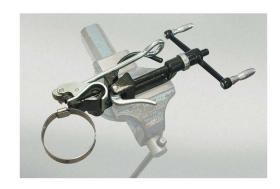
Montage mit Bandimex Spannwerkzeug W 001 und Bandimex Adapter V 001 (a) bzw. V 050 (b). Bandimex Spannwerkzeug in Schraubstock einspannen. Bandimex Adapter auf Werkzeugnase setzen, Schelle in Werkzeug einführen und das Bandende mit dem
