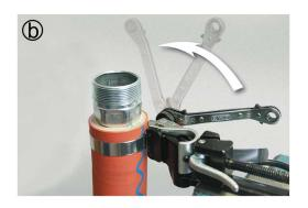
Die fertig montierte Bandimex Vorgefertigte Schelle erfordert kein nachträgliches Hämmern oder Schlagen.
