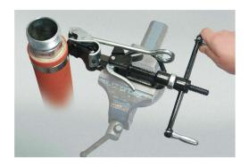
Schlauch durch die Schelle stecken und Kurbel des Bandimex Spannwerkzeuges nach rechts drehen. Um das Anziehen des Bandes zu kontrollieren, legt man einen Finger auf die Seite der Schlaufe, in die das Band eingezogen wird, und dreht die Kurbel, bis die gewünschte Spannung erreicht ist. Wenn das Band nicht mehr unter der Schlaufe durchgezogen wird, ist die maximale Zugkraft erreicht.
